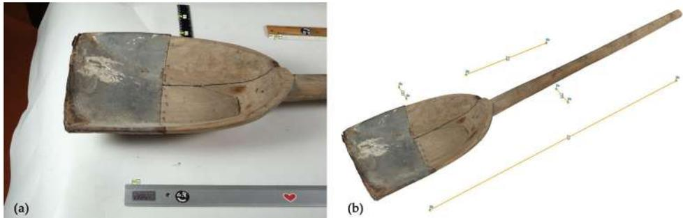
Fig.6.4 (a) Foto della pala del *torototela*; sullo stage sono state posizionate delle righe graduate per poter successivamente scalare il modello 3D. (b) Modello 3D della pala scalato grazie a quattro misure collimate direttamente sui fotogrammi in corrispondenza delle righe graduate disposte sul set.
